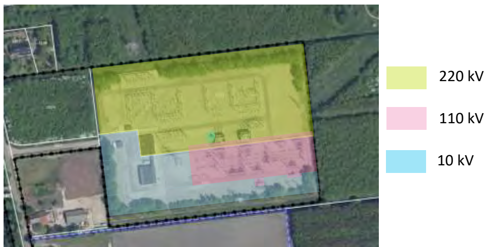
Figuur 3.3 Indeling terrein station Zeijerveen (spanningsniveau)
